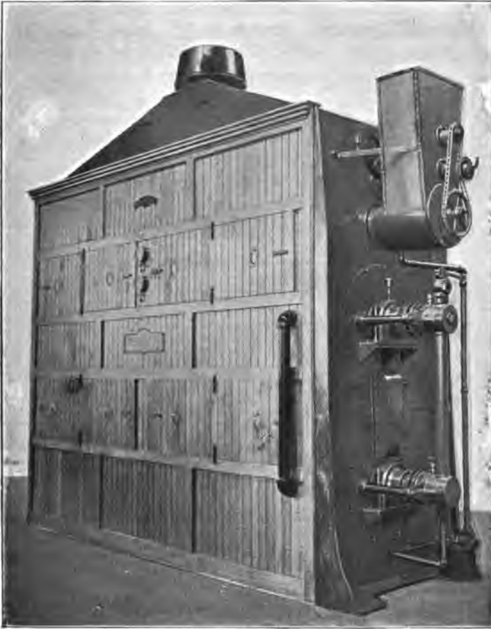
Fig. 99. Trockenapparat Patent Otto in amerikanischer Ausführung. Geschlossene Aussenansicht.
